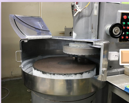
ゼネレーターを使用し、まず粗研磨で厚みを揃えます
