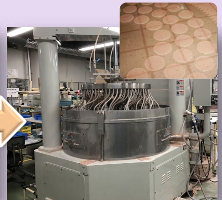
ポリッシュ機を用いて、お客様のご指定の厚みに研磨し透明に仕上げます。光学ガラスへ対応した超精密研磨加工により任意の精度に上げることが可能です
